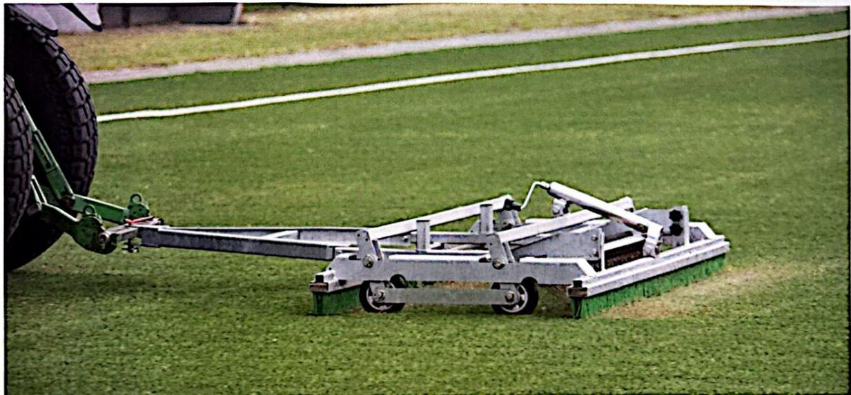
Abbildung 8: Die heiler Bürsten- und Striegeleinheit – hier das Bürsten ohne Striegel
