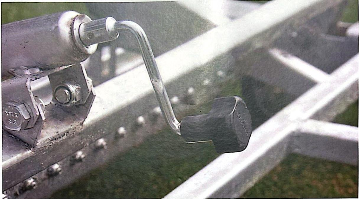
Abbildung 22: Mit der Kurbel passen Sie die Höhe des Fahrwerks an
