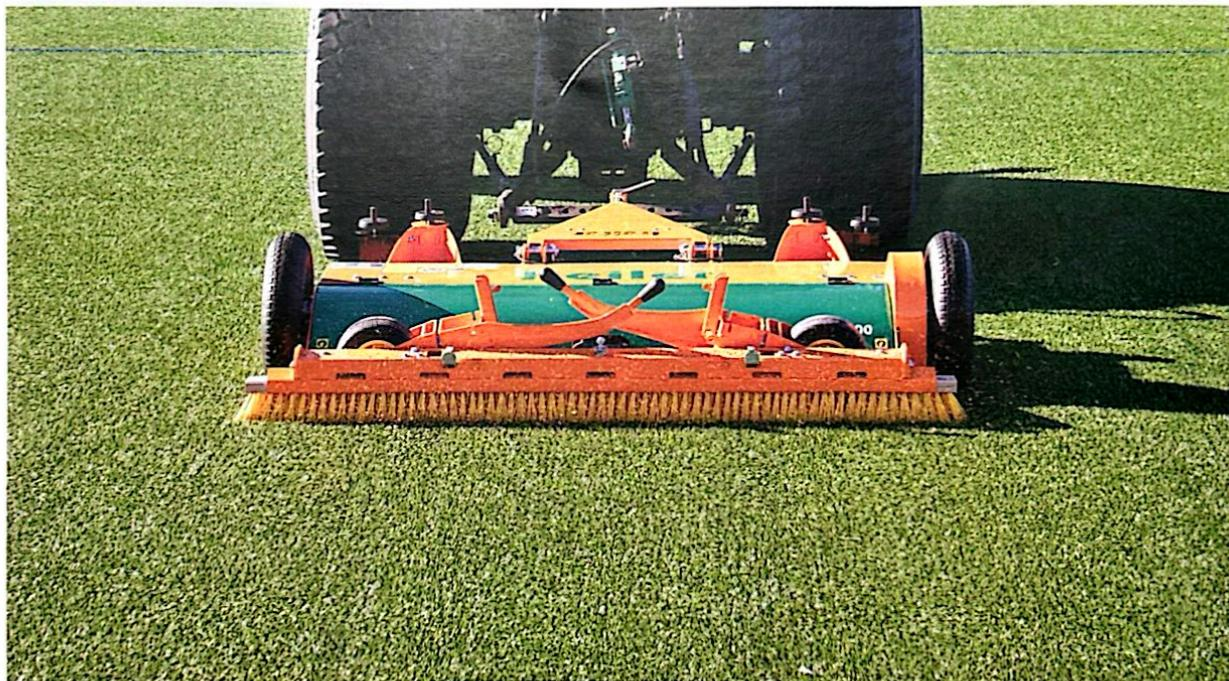
Abbildung 24: Für die Pflege von Vollkunstrasensystemen eignet sich der TurfCare mit speziellen Bürsten
