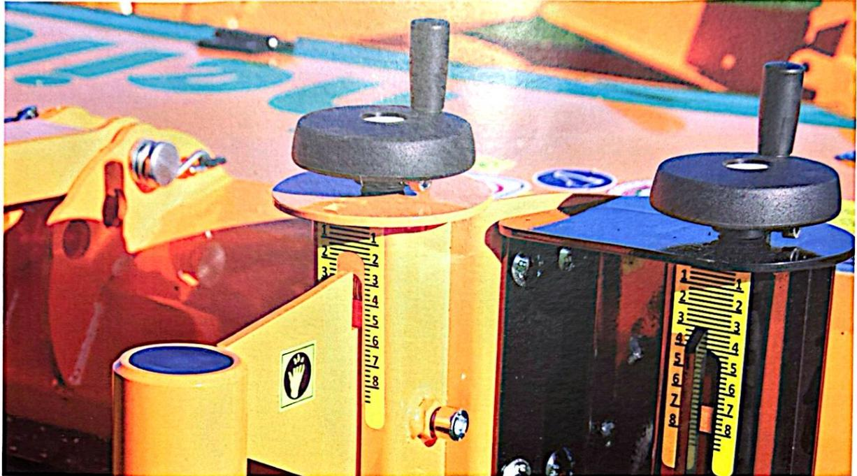
Abbildung 25: Die äußeren Kurbeln (hier rechts) verändern die Arbeitshöhe der Striegelleiste, die inneren Kurbeln (hier links) die Arbeitshöhe der Rotationsbürste
