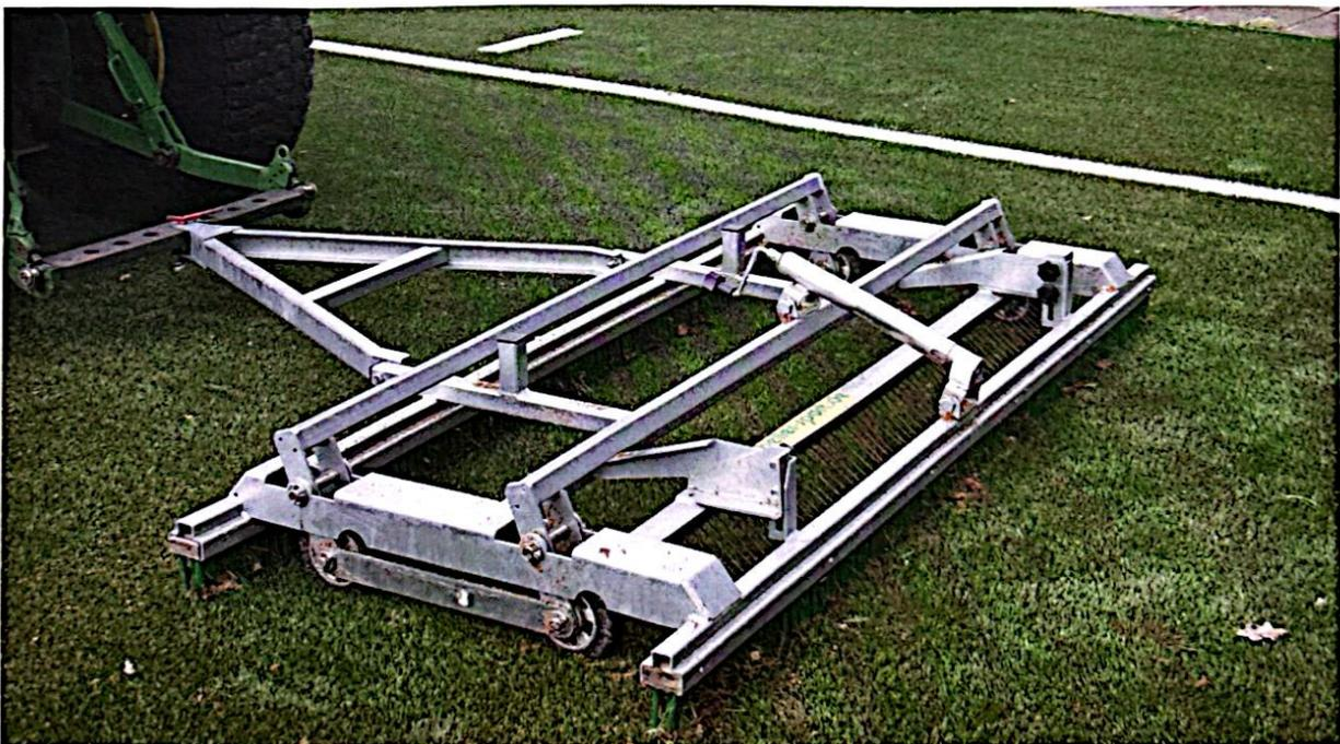
Abbildung 21: Die heiler Bürsten- und Striegeleinheit kann mittels Deichsel befestigt werden
